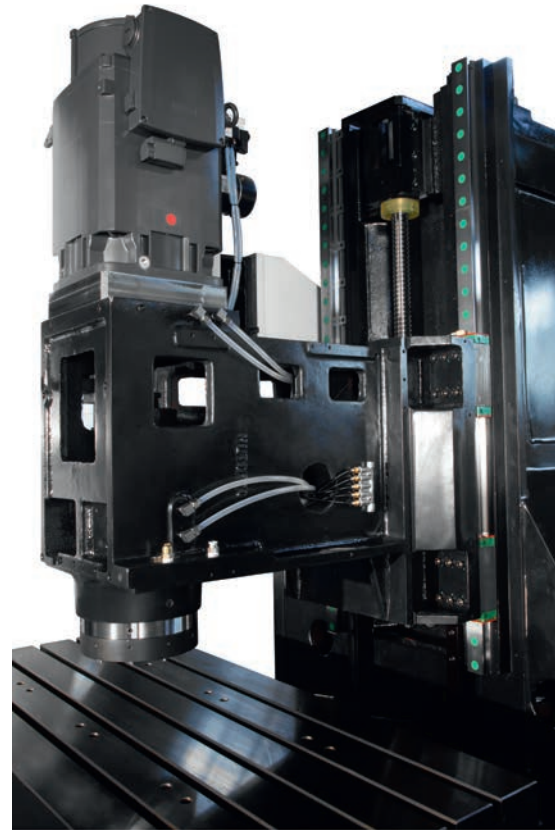
Gusseisen, das zum Spannungsabbau gehärtet wurde, um strukturelle Stabilität ohne Verformung zu gewährleisten
