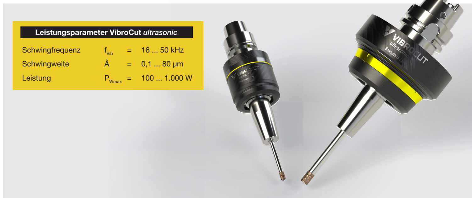
Abbildung 6: Ultraschall-Werkzeughalter für VibroCut ultrasonic
