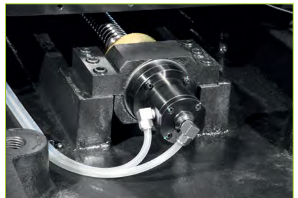
Refroidissement de la vis à bille par huile (en option pour VF1100, VF1300, VF1500)
